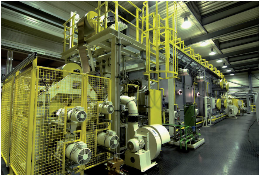
Bild 3: WSP-Kompakt-Schwebeofen für Bänder 0,1 mm bis 1,8 mm Dicke und 270 mm bis 400 mm Breite, max. Betriebstemperatur 850 °C. Blick auf die Antriebsseite
