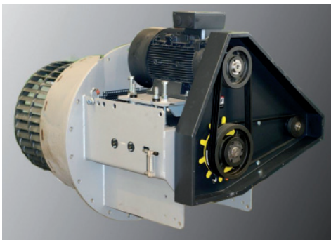
Bild 1: WSP-Hochtemperatur-Ventilator; Trommelläufer D800 mit rundem Stopfen, Trudelmotoren für Notstrombetrieb, Sperrgaswellendichtung und Riementrieb
