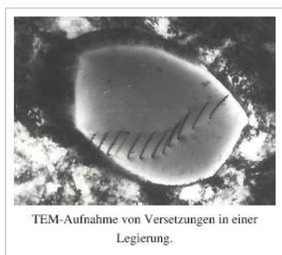
Bild 1: Schematische Darstellung und transmissionselektronenmikroskopische Aufnahme von Versetzungen in einem kristallinen Gitter (Quelle: Wikipedia)
